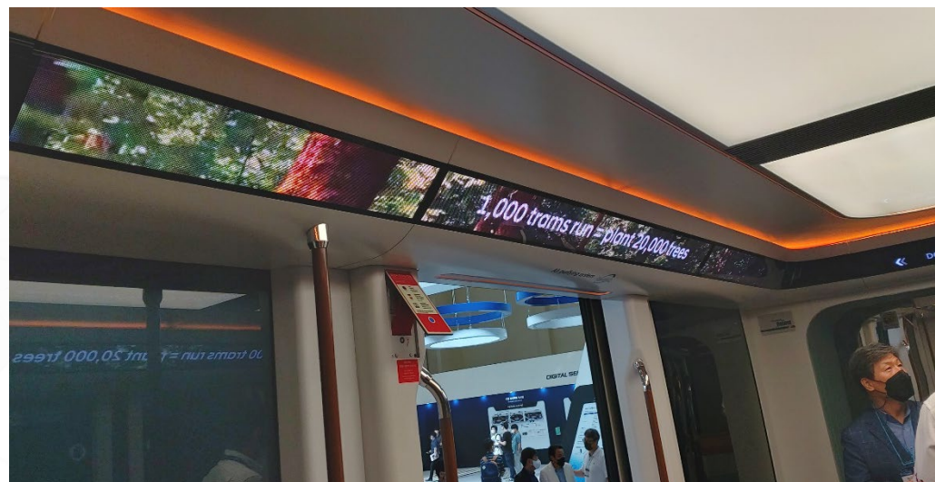
2021 현대 ROTEM 수소 TRAM용 실내에 설치된 마바의 FLED
